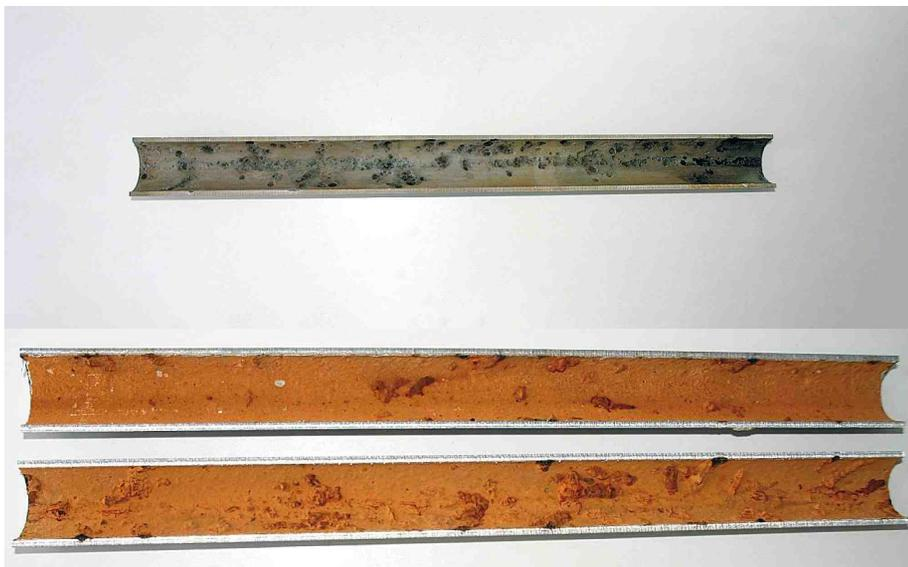
Bilder 1 und 2: Typisches Schadensbild einer Lochkorrosion, vor (oben) und nach (unten) Entfernung der Deckschicht. Bilder: Grünbeck Wasseraufbereitung GmbH
