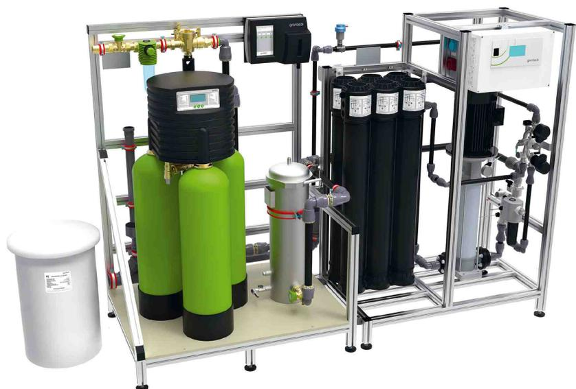
Bild 3: Aufbereitungsanlage auf Rahmensystem. Zu ihren Vorteilen zählt die komplette Verrohrung zwischen den Anlagenkomponenten einschließlich Verdrahtung und Werkstattprüfung.
