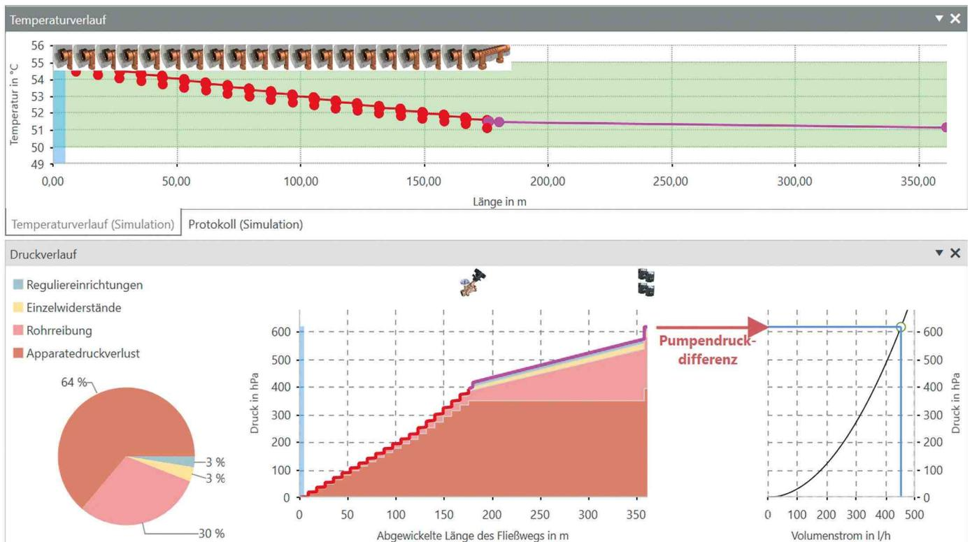
Bild 6: Druck- und Temperaturverlauf im ungünstigsten Zirkulationskreis, Speicheraustrittstemperatur 55 °C, einreguliert über Strömungsteiler in Verbindung mit statischer Reguliertechnik (Kemper MultiFix-Zirkulationsregulierventile). Bild: Kemper
