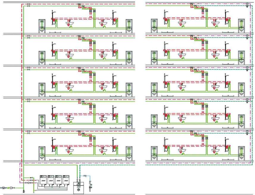
Bild 5: Krankenhaus mit 200 Nasszellen, horizontales Erschließungskonzept, Zirkulation über Strömungsteiler, einreguliert mit „MutiFix“-Zirkulationsreguliertventilen. Bild: Kemper
