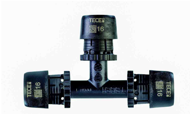
Der Aufbau der Fittings von TECE hilft dabei, Flüchtigkeitsfehler bei der Installation zu vermeiden: Einstecktiefe und Presszustand sind zu erkennen und unverpresst bleiben die Fittings undicht. Bilder: TECE
