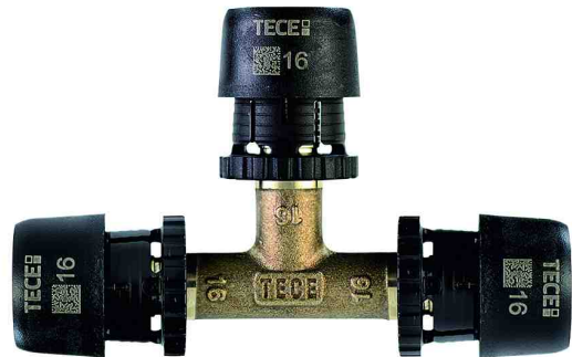
Der Aufbau der Fittings von TECE hilft dabei, Flüchtigkeitsfehler bei der Installation zu vermeiden: Einstecktiefe und Presszustand sind zu erkennen und unverpresst bleiben die Fittings undicht. Bilder: TECE
