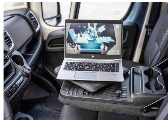
In diesem „Movano“ ist die gesamte Sitz-Rückenlehne zum „Eat & Work“ heruntergeklappt. Die Variante bietet eine Becherablage und eine drehbare Platte, auf der ein Laptop Platz hat.
