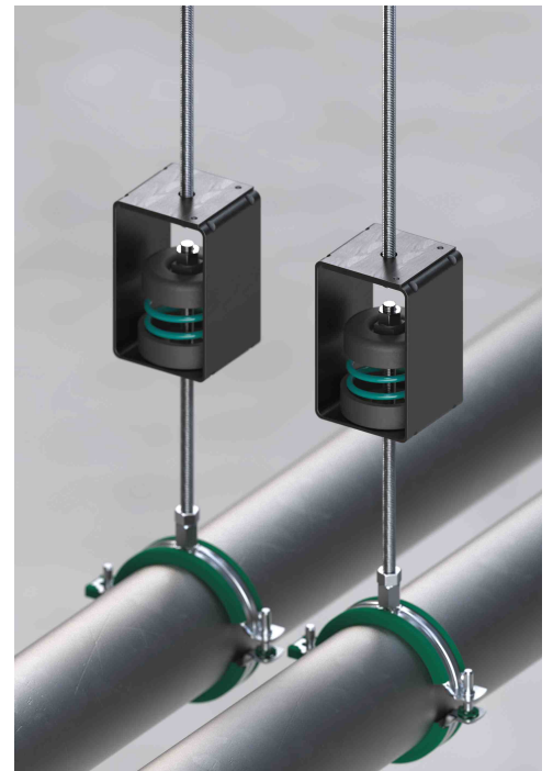
Vibroakustische Isolatoren reduzieren Schwingungen und spielen eine wesentliche Rolle bei der Minimierung von Lärm in der TGA. Hier: Stahlfederhänger für Rohrleitungen.
