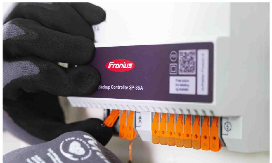
Mit dem Backup Controller schaltet das System automatisch auf Notstrom um, wenn es Probleme mit der Stromversorgung gibt.
