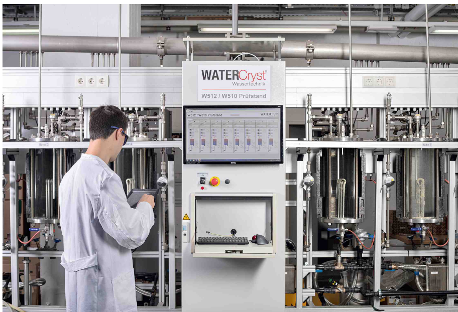
Bild 3: Kalkschutzgeräte werden nur dann als wirksam bewertet, wenn sie während der Prüfung die Kalkablagerungen in den Elektroboilern bei 80 °C um mindestens 80 % gegenüber den Referenzstrecken ohne Kalkschutz reduzieren. Bild: Chris Reichl
